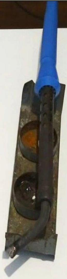
**Те, кто сталкивался с этой задачей, знают, что алюминий плохо поддаётся пайке. Виной тому тонкая оксидная плёнка, быстро образующаяся на поверхности этого металла на открытом воздухе. Поэтому для пайки алюминия применяют специальные флюсы. Перед пайкой нужно зачистить провод ножом. Поверхность провода должна быть светло – серебристой, а не тёмно – серой**
