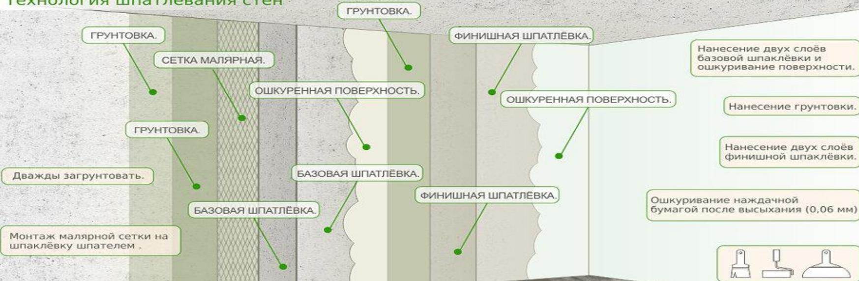
наносит шпателем первый тонкий слой выравнивающей шпаклевки; при больших неровностях применяют еще 2-3 слоя; дают шпаклевке высохнуть; выполняют финишную шпаклевку для устранения мелких дефектов; после полного высыхания затирают стену наждачной бумагой, для получения идеально гладкой поверхности.
